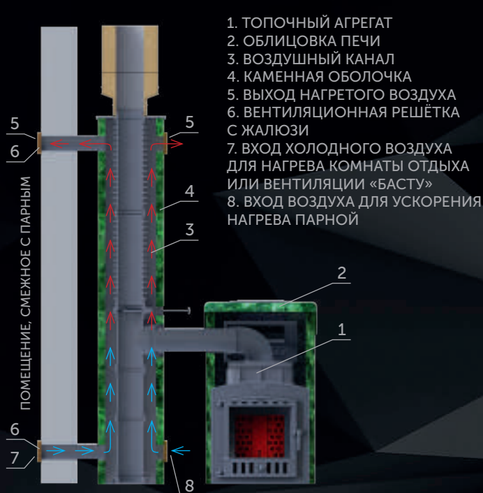
СХЕМА РАБОТЫ ДЫМОХОДА С ОБОГРЕВОМ СМЕЖНОГО ПОМЕЩЕНИЯ
