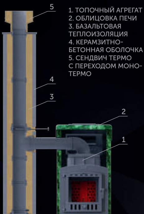
СХЕМА ДЫМОХОДА С ТЕРМОСТОЙКИМ КОНТУРОМ
