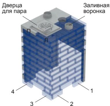
**Важно!** Перед первым использованием после установки облицовки необходимы предварительные протопки. Это необходимо для медленного удаления влаги из каменной породы. Протопка производится в 2 этапа с использованием 50% мощности топочного агрегата (достигается загрузкой дров не более 1/2 объема топки и регулировкой уровня тяги) в течение 2-х часов и дальнейшего полного остывания.
